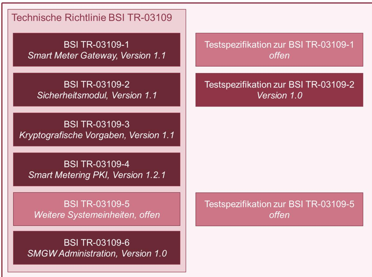
Abbildung 3: Struktur und aktueller Stand der technischen Richtlinie BSI TR-03109. Quelle: Angepasste Abbildung 2.1 in (Bundesamt für Sicherheit in der Informationstechnik, 2021c).
