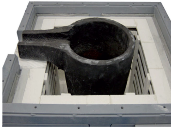
Abbildung 36: Foto eines elektr. widerstandsbeheizten Ofens mit Siliziumcarbid-Schmelztiegel
