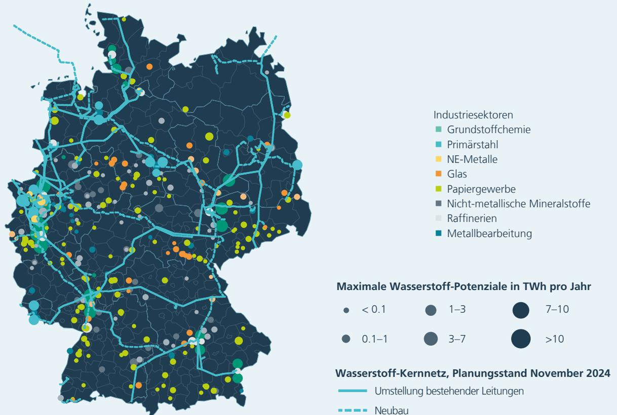
Abbildung 9: Abbildung des für das Jahr 2032 genehmigten Wasserstoffkernnetzes und energieintensiver Industriestandorte mit ihrem theoretisch möglichen Wasserstoffbedarf<sup>17</sup>
