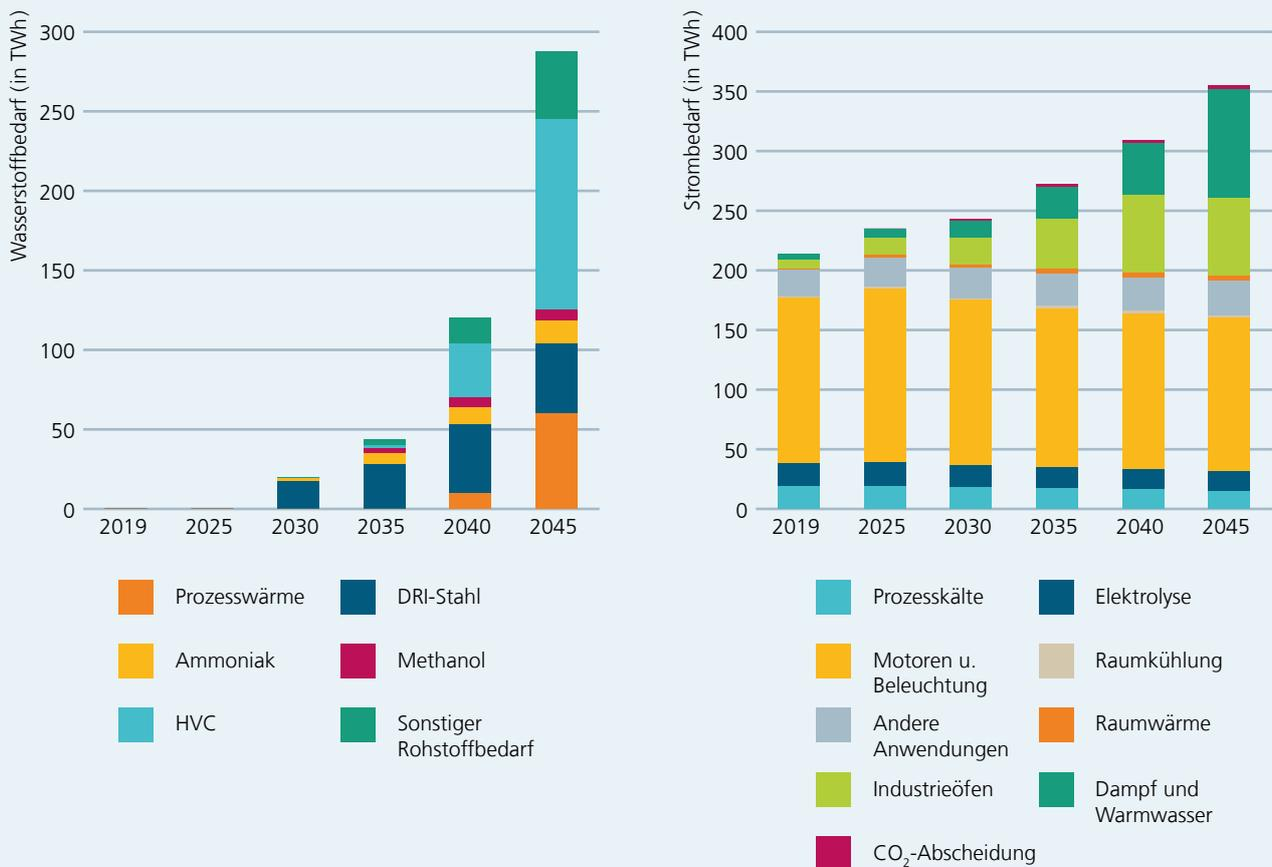
Abbildung 2: Zukünftiger Bedarf der Industrie an Wasserstoff und Strom im Elektrifizierungsszenario O45-Strom der Langfristszenarien (Quelle: Fleiter et al. 2024)<sup>4</sup>
