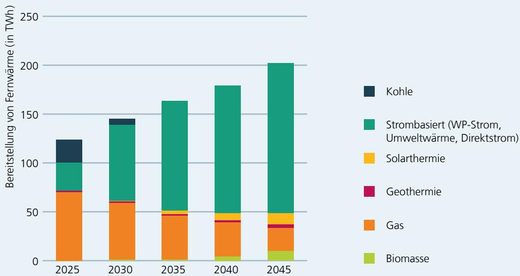
Abbildung 18: Bereitstellung der Fernwärme nach Energieträger (Eigene Darstellung, basierend auf Daten aus Luderer et al. (2025)<sup>5</sup>)
