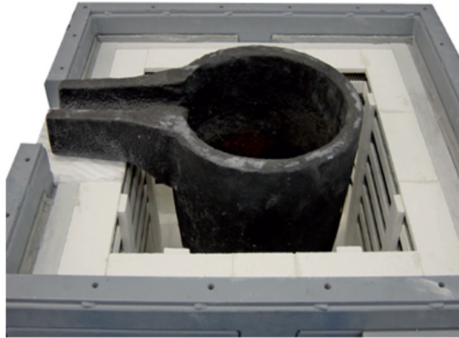
Abbildung 36: Foto eines elektr. widerstandsbeheizten Ofens mit Siliziumcarbid-Schmelztiegel
