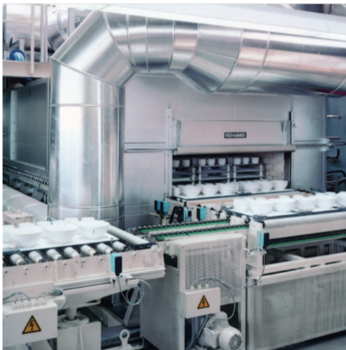
Abbildung 110: Foto und schematische Darstellung eines Rollenofens für den Porzellanglattbrand
